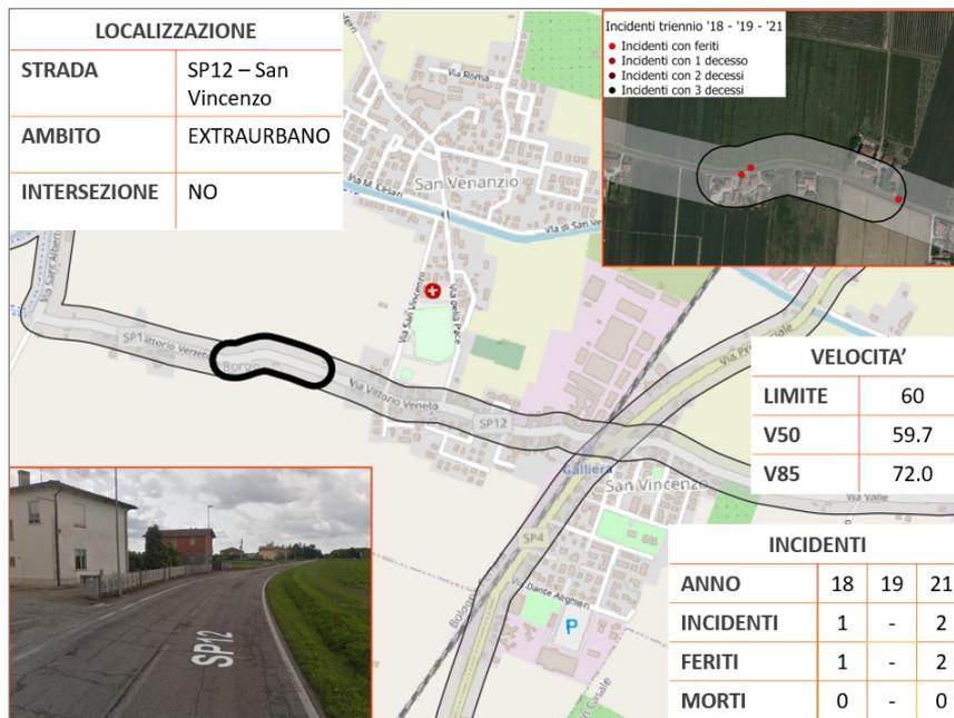
La velocità tenuta dall'85° percentile risulta superiore di 12 km/h al limite imposto. La velocità e il tracciato geometrico della tratta in esame potrebbero essere due delle principali concause di sinistrosità.
