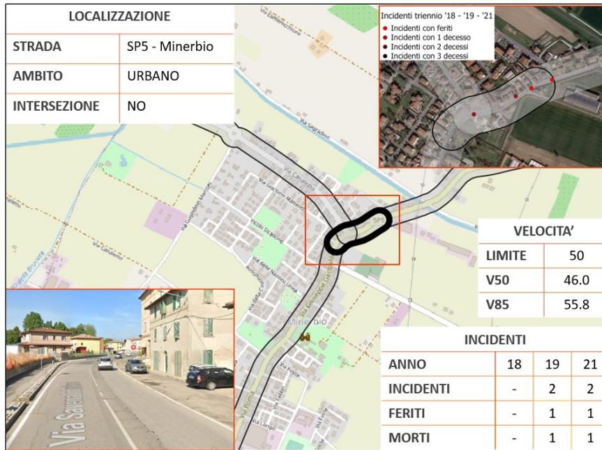
Sul tratto non si registrano velocità alte, anche a causa della presenza di un semaforo, che quando rosso abbatte la velocità sul tratto.
