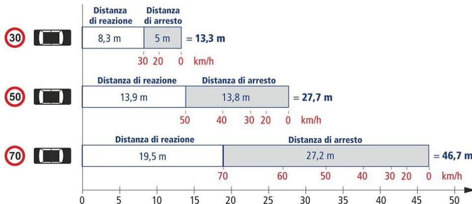
Grafico dello spazio complessivo di frenata, somma di distanza di reazione + distanza di arresto, alle diverse velocità
