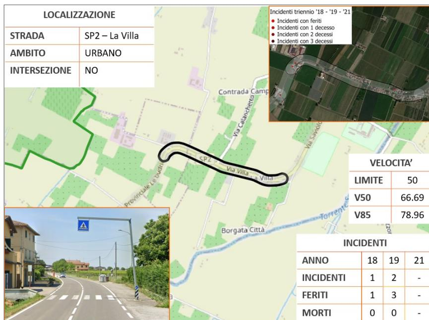
Attraversamento urbano percorso a velocità elevate, con traffico di pesanti non trascurabile.
