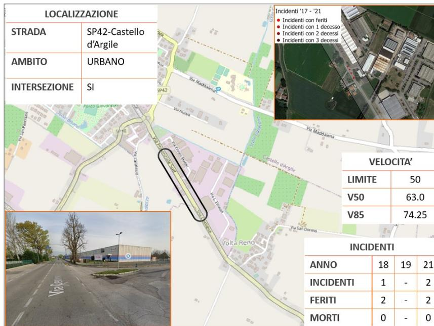
Considerando l’ambito urbano le velocità del flusso risultano eccessive. Durante il sopralluogo abbiamo assistito a sorpassi di mezzi pesanti in corrispondenza dell’attraversamento pedonale posto sul ramo nord dell’intersezione.
